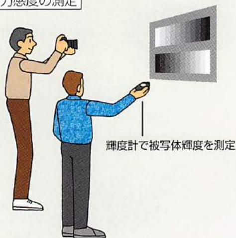
標準出力感度は、撮影した画像の明るさが所定の基準値に写るよう規定された感度です。測定方法は、例えばグレースケールチャートなど適当な被写体を撮影し、着目する部分の出力レベル (画像の明るさ) が118 (8ビット画像の場合) ※になるよう露出を合わせ、そのときの像面露光量 (撮像素子に入ってきた光の量) を、被写体輝度と露出値から求めて感度を算出します。
