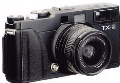
標準サイズ(24mm×36mm)に加え、フルパノラマサイズ(24mm×65mm)の撮影を可能にした「デュアルフォーマット」採用の35mmフィルム専用のレンズ交換式距離計連動レンジファインダーカメラ。6×4.5判並のイメージサークルを持つ、専用の高性能スーパーEBCフジノン交換レンズは、シャープで極めて高画質な描写を実現します。本体はアルミダイキャスト製、外装はチタンとステンレスを使用し、高い質感と耐久性を両立しております。
