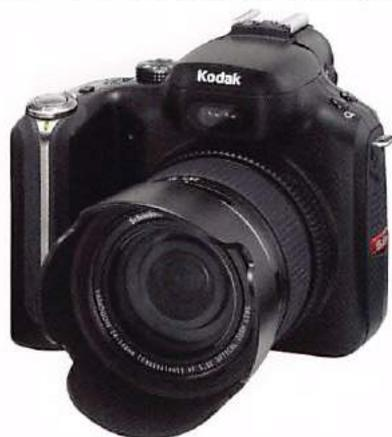
有効画素数:800万画素 撮像素子:総画素数830万画素、1/1.8型CCD 記録媒体:内蔵メモリー:32MB、対応メモリーカード:SDカード/MMCカード 記録方式:静止画:DCF準拠 EXIF2.21 (JPEG)・TIFF・RAW、動画:QuickTime (Motion JPEG) 記録画素数:静止画:8.0MP (3,264×2,448)/7.1MP (3,246×2,176) 3:2/5.0MP (2,560×1,920)/3.1MP (2,048×1,536)/0.8MP (1,024×768)、動画:VGA (640×480):30fps/QVGA (320×240):30fps 使用レンズ:シュナイダーレンズ フォーカス:ハイブリッドAF (TTL-AF+外部測距センサー)、マニュアルフォーカス、AF補助光あり シャッター
